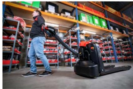
Der Niederhubwagen von PROFI verbinden kompakte Abmessungen, Effizienz und Komfort. Mit Tragkräften von 1000 - 2500 kg steht für jeden Einsatz das passende Gerät zur Verfügung. Die robuste Konstruktion und die hochwertigen Komponenten gewährleisten eine lange Lebensdauer und halten die Wartungskosten tief. Ausgerüstet mit modernsten Lithium-Ionen Akkus sind die Geräte bereits jetzt zukunftsfähig.
