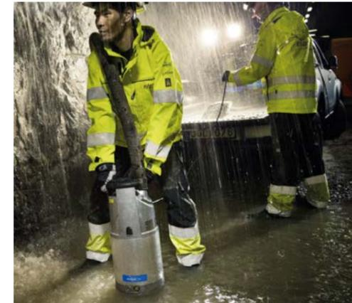
Die Reihe der **KS2600** Pumpen wurde für die professionelle Verwendung bei der Entwässerung unter schwierigen Bedingungen in Gruben, auf Baustellen, beim Tunnelbau oder an Industriestandorten entwickelt. Die KS2600 Pumpe steht für Zuverlässigkeit und ist mit Innovationen ausgestattet, die den Verschleiss am Laufrad und an den Dichtungen reduzieren. Mit einer KS2600 besitzen Sie eine Pumpe, die immer weiterpumpt, sogar unter den schwierigsten Bedingungen.
