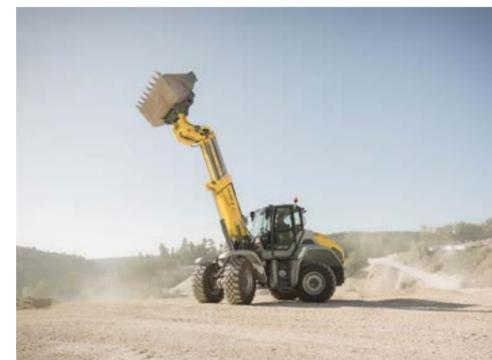
Die Z-Kinematik erweitert den vollwertigen Radlader um die Vorteile eines Teleskopradladers. Die teleskopierbare Ladeanlage ermöglicht eine grössere Reichweite, sowie Schütthöhe. Dank der hohen Stapel-, Ausschütt- und Überladehöhe ist das Be- und Entladen von hochwandigen LKWs möglich.
