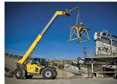
Basierend auf dem Know-how aus der Radlader-Entwicklung wurden die Maschinen konsequent auf Robustheit und Zuverlässigkeit ausgelegt. Dies zeigt sich zum Beispiel am torsionssteifen Schwerlastrahmen, der durch seine geschlossene Bauweise und großen Materialstärken die hohen Nutzlasten der Maschinen sicher aufnehmen kann. Ab dem 4407 wird der Teleskoparm zusätzlich seitlich im Rahmen abgestützt, um die Kräfte bei Ladearbeiten großflächig in den Rahmen einzuleiten.
