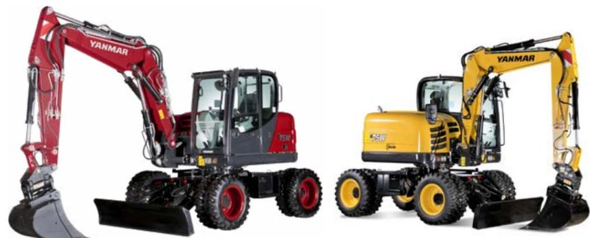
Der kompakte Kurzheck-Mobilbagger von Yanmar eignet sich ideal für Arbeiten auf engem Raum. Damit bietet er maximale Effizienz bei Grab- und Erdarbeiten sowie beim Verlegen von Rohrleitungen. Vier unabhängige Steuerkreise ermöglichen den Betrieb mit unterschiedlichen Anbaugeräten, während der Pendelwinkel von 14 Grad auch auf unebenen Böden für Stabilität sorgt.
