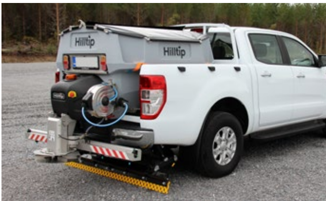
Optionale Salzwassersprühbalken und Schlauchspule
