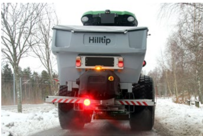
LED Arbeitsscheinwerfer (rot) und Warnlicht (orange)
