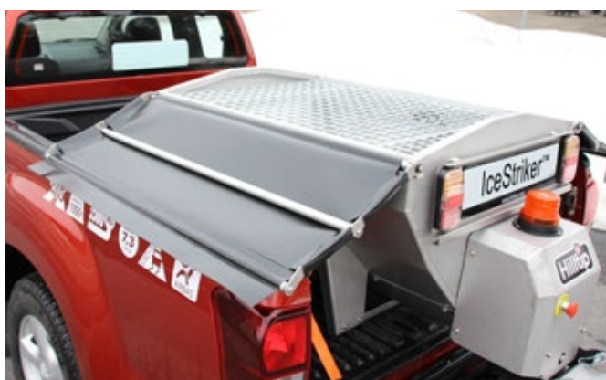
Zweiteiliger Planenmechanismus und Gitter
