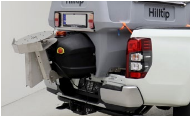
Klappbare Edelstahl-Spinner, entwickelt auch zum Streuen von sehr feuchtem Salz.
