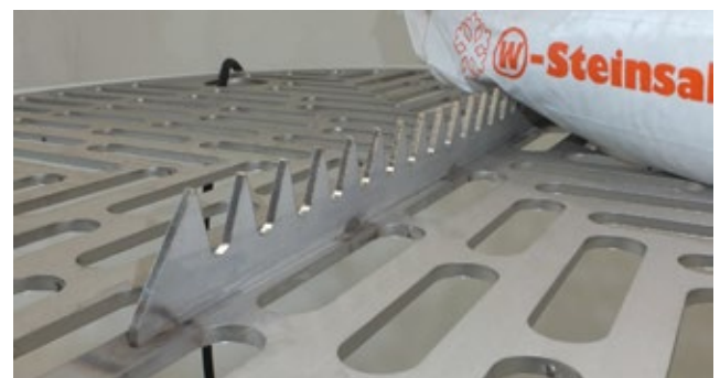
Cutter zum Öffnen der Salzsäcke
