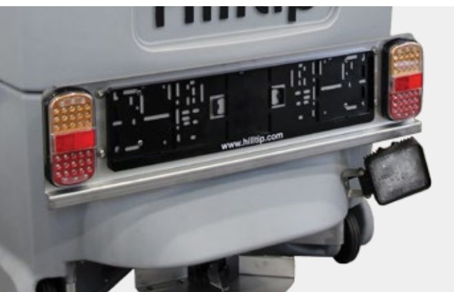
Nummernschild-Kit, Rücklicht und LED-Arbeitsscheinwerfer
